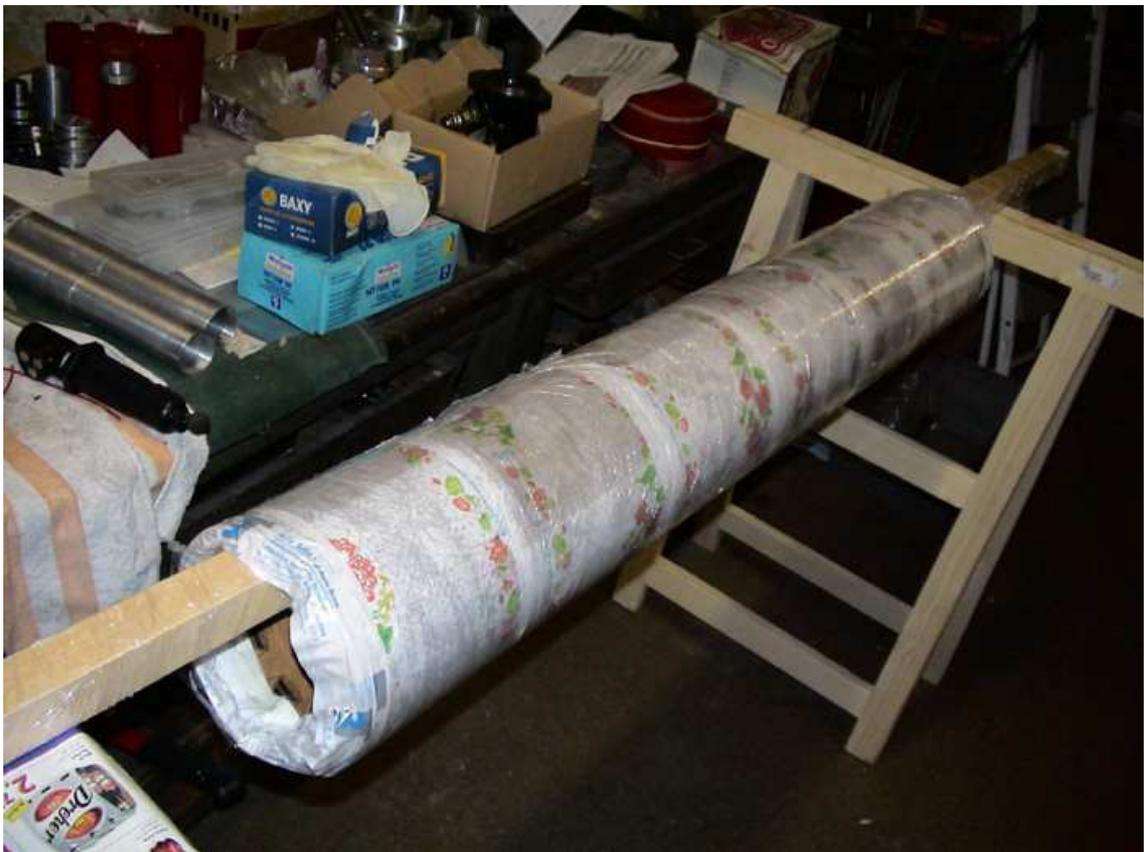
Si passa all'unione del corpo centrale con le pinne mediante incollaggio con della colla epossidica ad alta resistenza.
