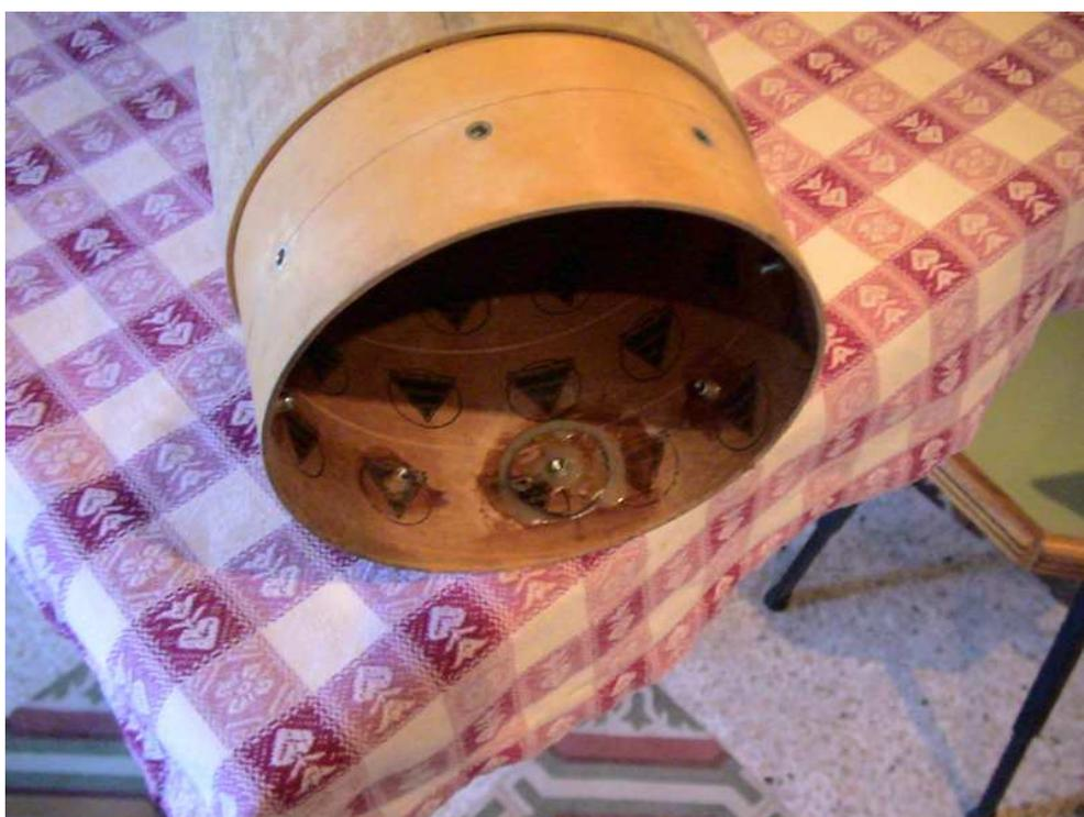
Inserti fissaggio M5 in particolare quello rinforzato per fissaggio rail guide
