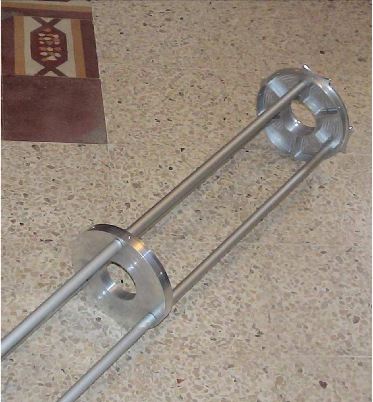
Particolare della piastra posteriore porta motore: si possono vedere le nervature fatte per ottenere una maggiore rigidità della stessa per poter sopportare la spinta del motore.
