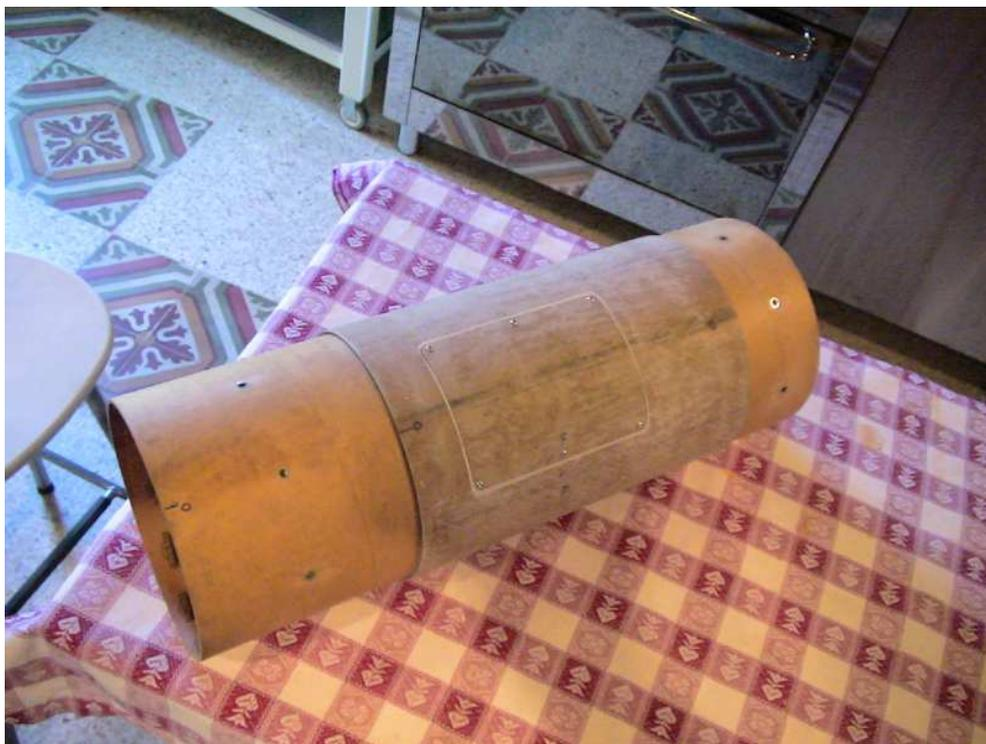
Sede portello con inserti per fissaggio M3
